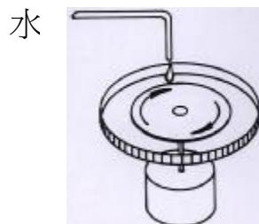
8. **加濕輸送帶或旋轉輪：**為將輸送帶或轉輪直接放在水槽上，只底部略為浸在水中，轉動時浸水潮濕部份的表面與吹過來的風接觸時會起熱焔交換現象，達到增加空氣濕度目的。
