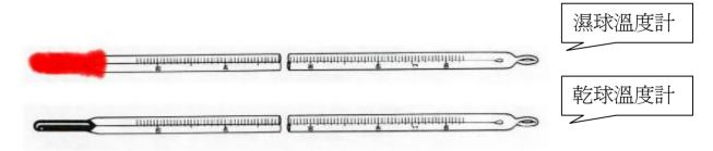
手搖式乾濕球溫度計原理相同,由兩個溫度計併列在一只特殊架上,並附有轉環之把手使其可輕易旋轉。並非利用流動空氣冷卻濕球,而是當感溫球上的紗布上的清水飽和後,將其快速在空氣中旋轉約一分鐘後,再讀取 DB 及 WB 溫度計上的值。此過程需重複數次以記錄最低 WB 溫度值。此種設計在結凍以下溫度甚難達到正確效果。
